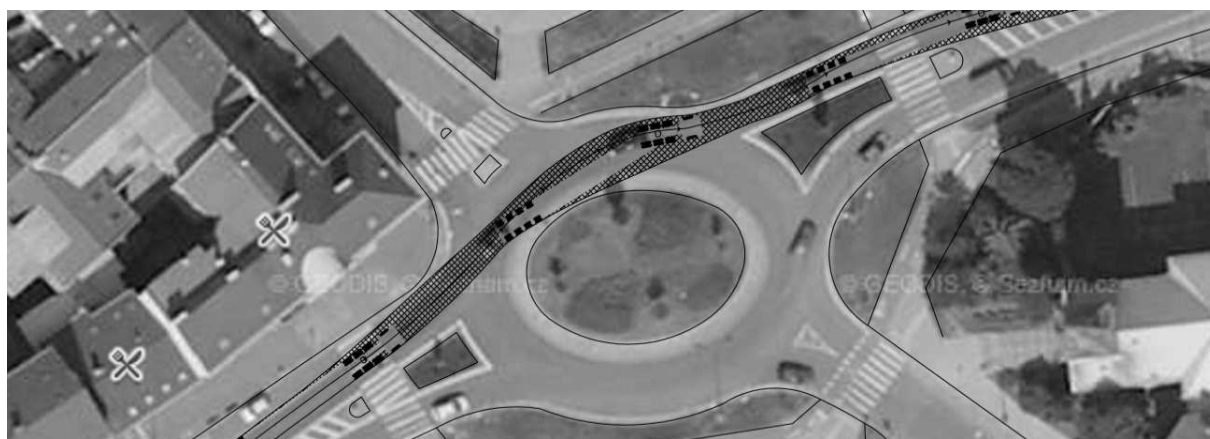
Obr. 15: Simulace průjezdu v protisměru na okružní křižovatce v Přerově
