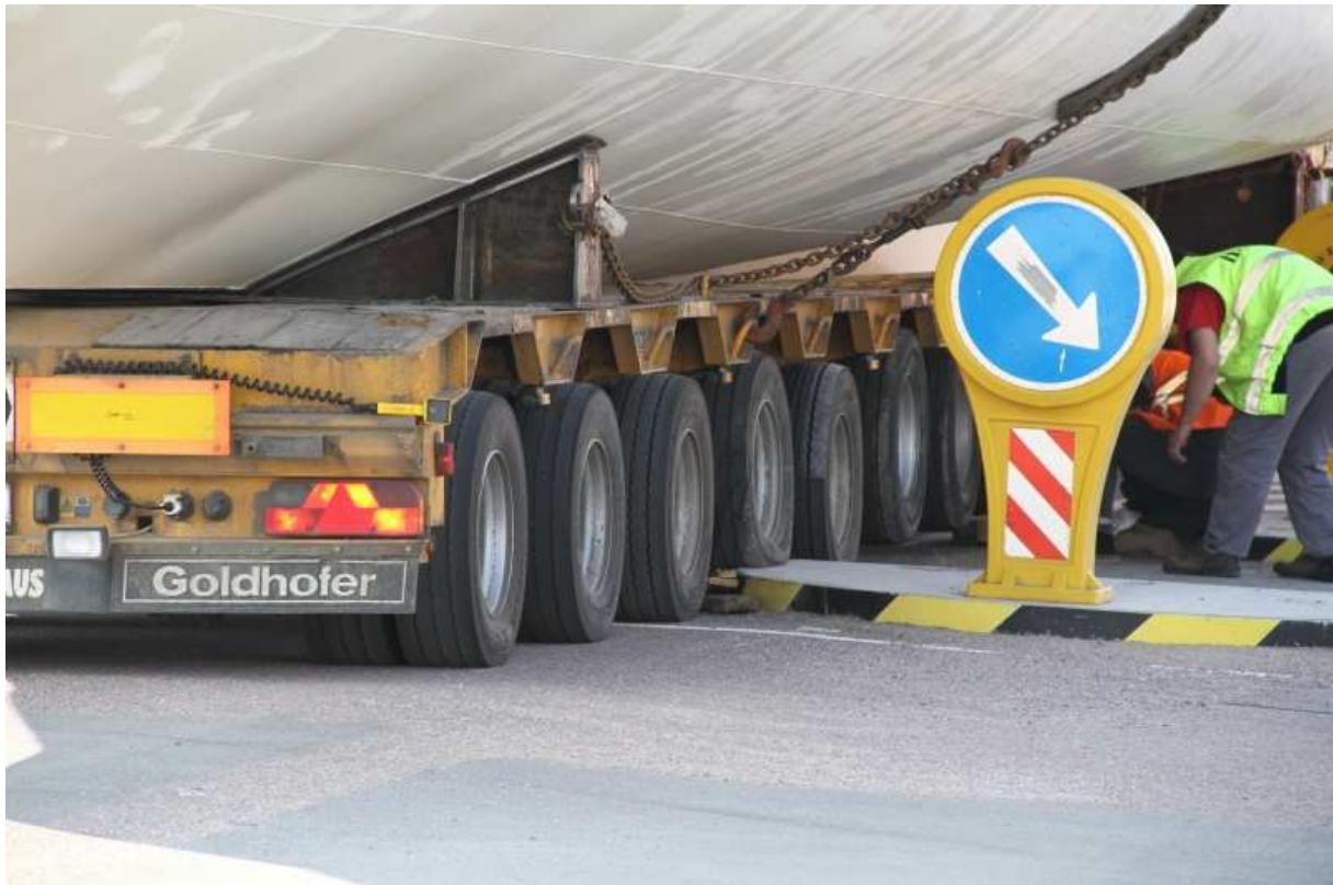
Obr. 2: Vypodkládání při přejezdu přes dopravní ostrůvek
