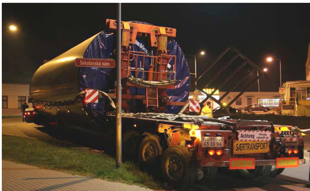
Obr. 11: Souprava: MAN TGX 41.540 8x4/4 BLS + DOLLY + THP/ET 2+4 – hmotnost až 115
