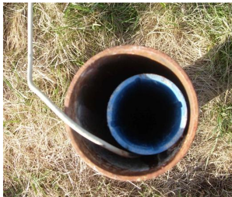
Obr. 5 Upevnenie koaxiálneho káblu s inklinometrickým obalom
