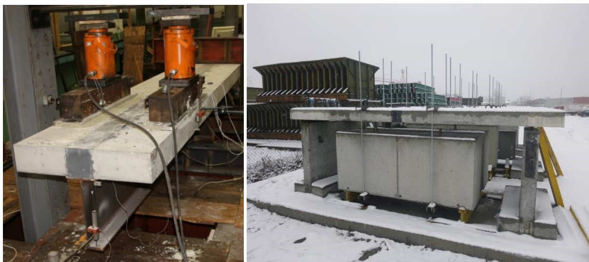
Obrázek 55 Vlevo zkouška spoje nosníku a desky, vpravo dlouhodobé zatěžování spoje dvou panelů čtyřbodovým ohybem [118].
