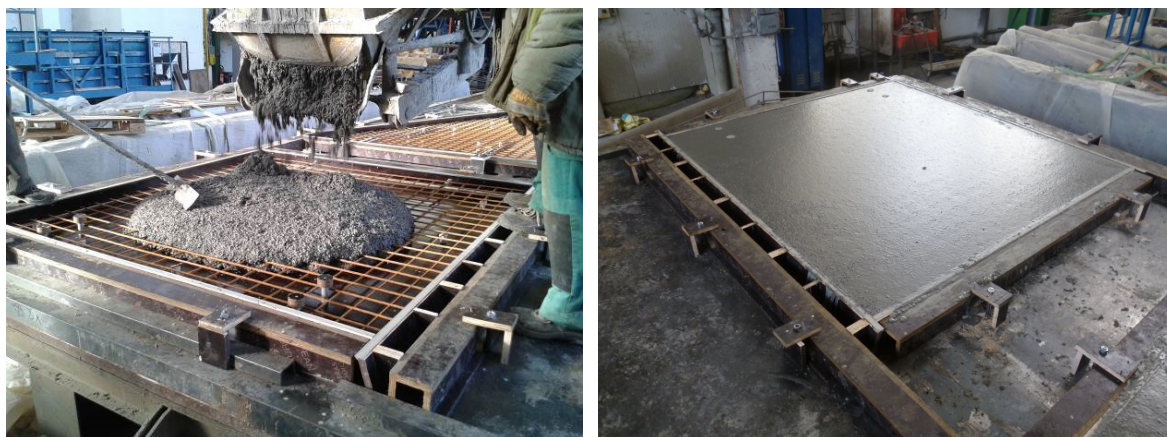
Obrázek 119 Vlevo ukládání materiálu do bednění deskových dílců. Vpravo hotový deskový dílec před odbedněním.
