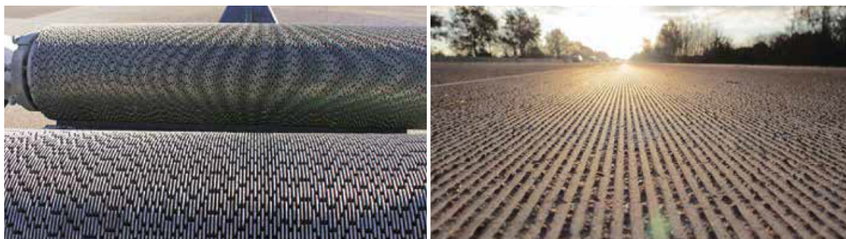
Obrázek 37 Vlevo řezná hlava, vpravo typická textura diamantového brusu vozovky [100].
