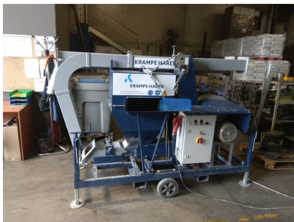
Obrázek 95 Vlevo složený rozdružovač. Vpravo dávkování drátků do autodomíchávače.
