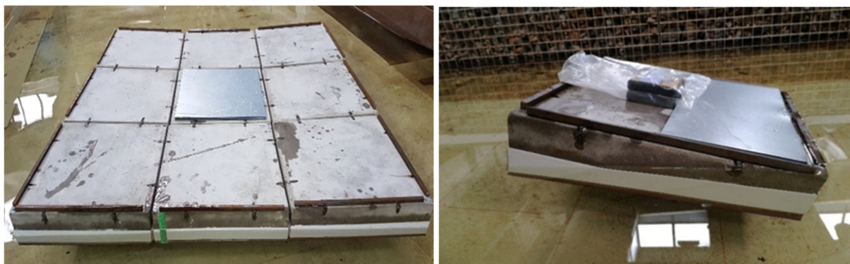
Obrázek 132 Vlevo plošná skupina prvků zatížená 4000 g na prostředním prvku skupiny. Vpravo osamělý prvek zatížený 2000 g na polovině paluby.
