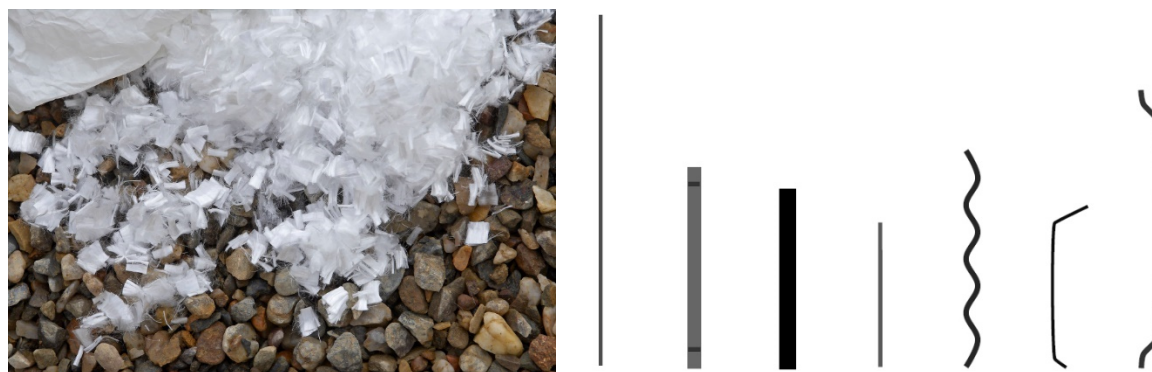
Obrázek 14 Vlevo polymerní mikroválákna, vpravo různé typy ocelových drátků.
