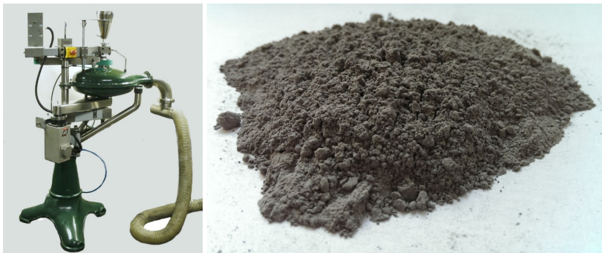
Obrázek 17 Vlevo TRITON M – II – dvourotorový protiběžný vysokorychlostní mlýn (Ecological Investment Group s.r.o.). Vpravo fotografie mechanicky aktivovaného betonového recyklátu.
