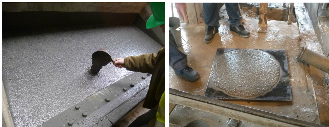
Obrázek 118 Vlevo čerstvý vysokohodnotný beton, vpravo zkouška konzistence čerstvého vysokohodnotného betonu.
