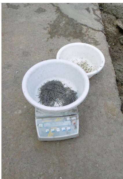
Obrázek 97 Vlevo přístroj pro magnetickou separaci drátků z čerstvého drátkobetonu. Vpravo vážení zachycených drátků.
