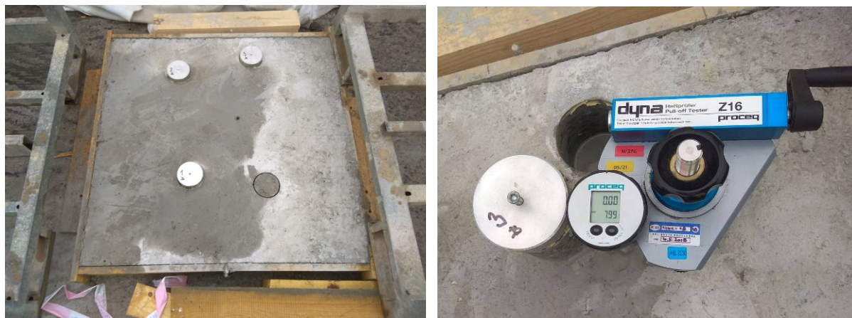
Obrázek 99 Provádění odtrhové zkoušky vývrťů odtrhoměrem Dyna.
