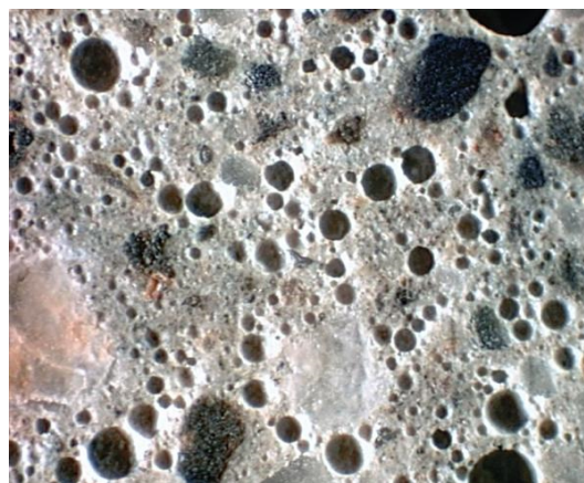
Obrázek 13 Vlevo ukázka chemické struktury polykarboxyláteteru. Vpravo fotografie mikrostruktury provzdušněného betonu.
