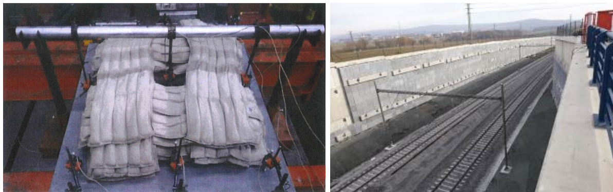
Obrázek 69 Vlevo zatěžovací zkouška panelu, vpravo fotografie realizace [146].
