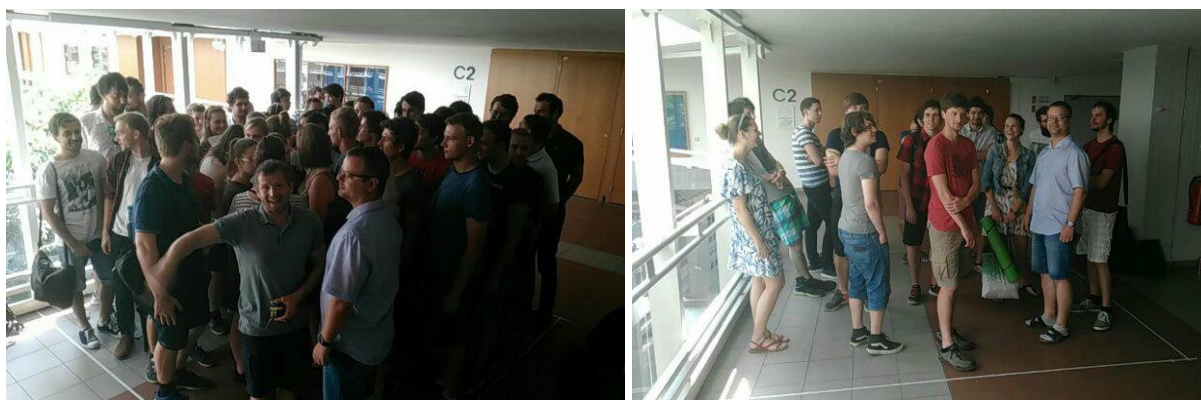
Obrázek 129 Vlevo maximální teoretické zatížení prvku mola – 51 osob (4000 kg) na ploše 3,3 x 3,3 m. Vpravo maximální dovolené zatížení prvku mola – 15 osob (1200 kg) na ploše 3,3 x 3,3 m.
