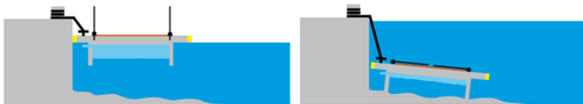
Obrázek 123 Základní myšlenka systému ponorných mol. Vlevo plovoucí molo s napuštěným vzduchovým vakem, vpravo ponořené molo s vypuštěným vzduchovým vakem (autor: Jakub Fabel).
