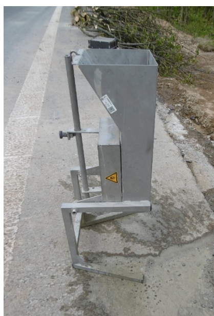
Obrázek 97 Vlevo přístroj pro magnetickou separaci drátků z čerstvého drátkobetonu. Vpravo vážení zachycených drátků.
