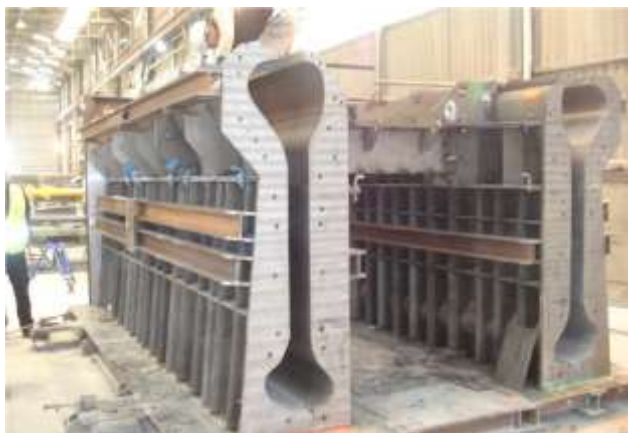
Obrázek 3-7 Forma nosníků pro lávku Pont du Diable
