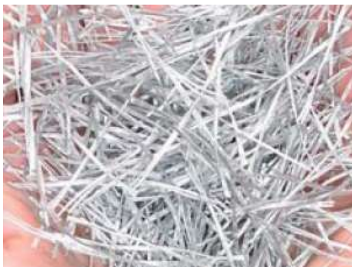
Obrázek 2-8 Syntetická vlákna ze speciální směsi polypropylénu a polyetylénu [24]
