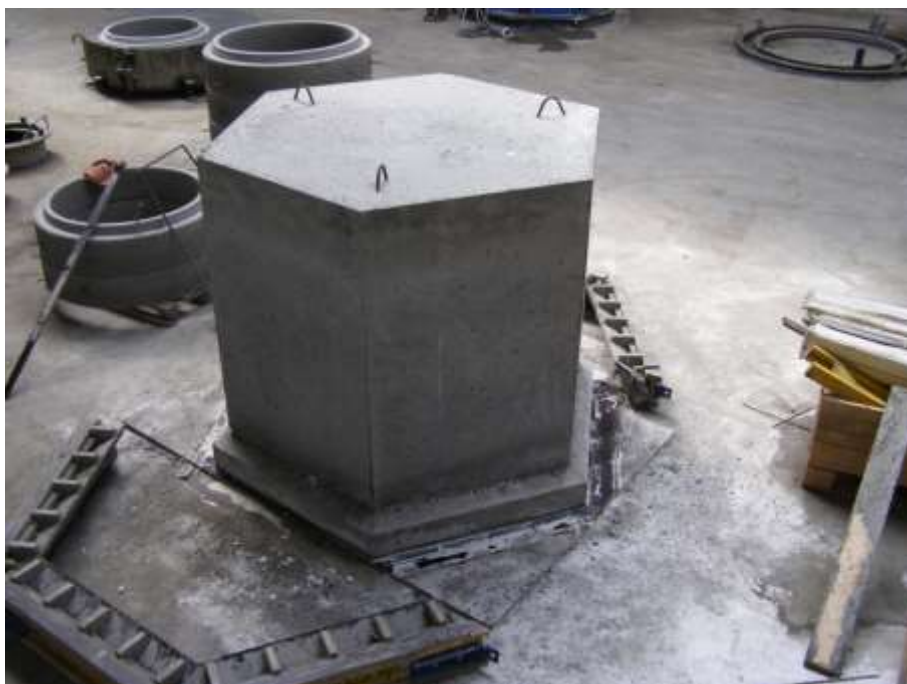
Obrázek 2-50 Pohled na odformovaný prefabrikát
