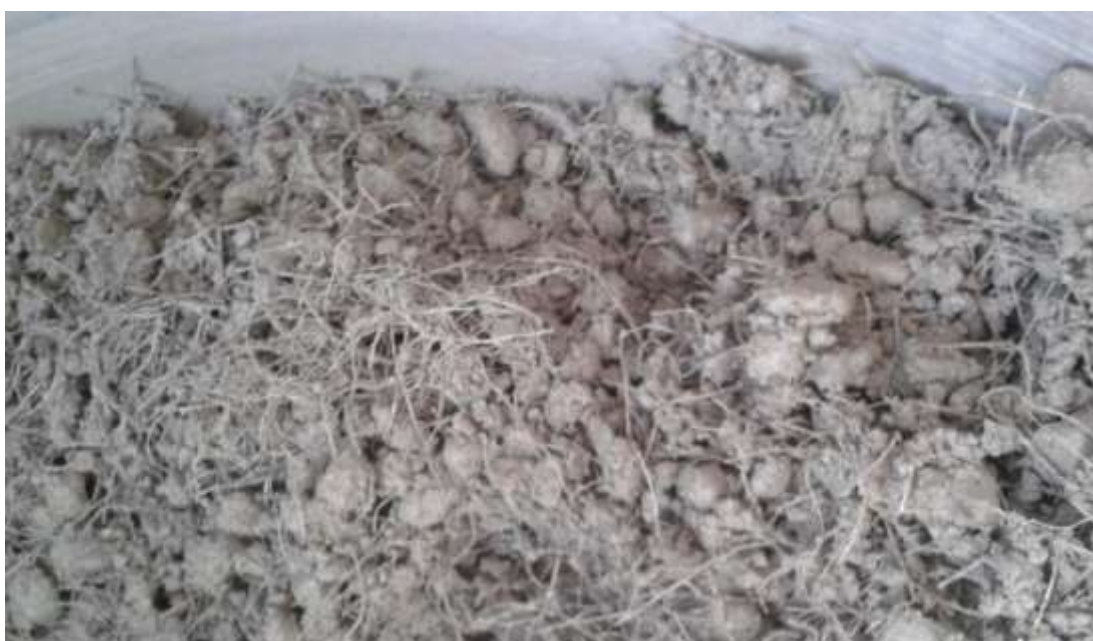
Obrázek 4-5 Čerstvá směs vláknobetonu s recyklovaným kamenivem
