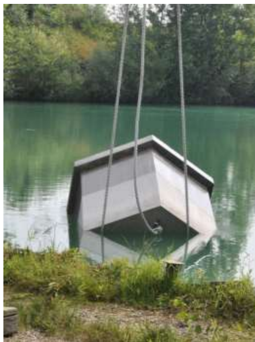
Obrázek 2-43 Samovolné otočení tělesa ve vodě
