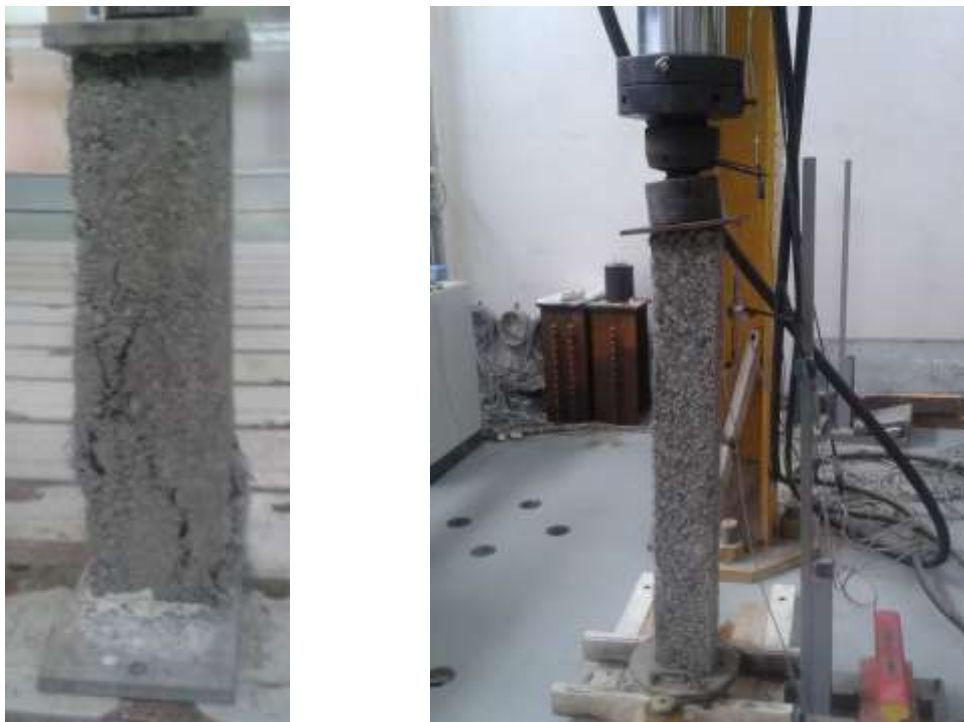
Obrázek 4-8 Tělesa po skončení zatěžování (vlevo 150/150/600 mm, vpravo 150/150/1200 mm)
