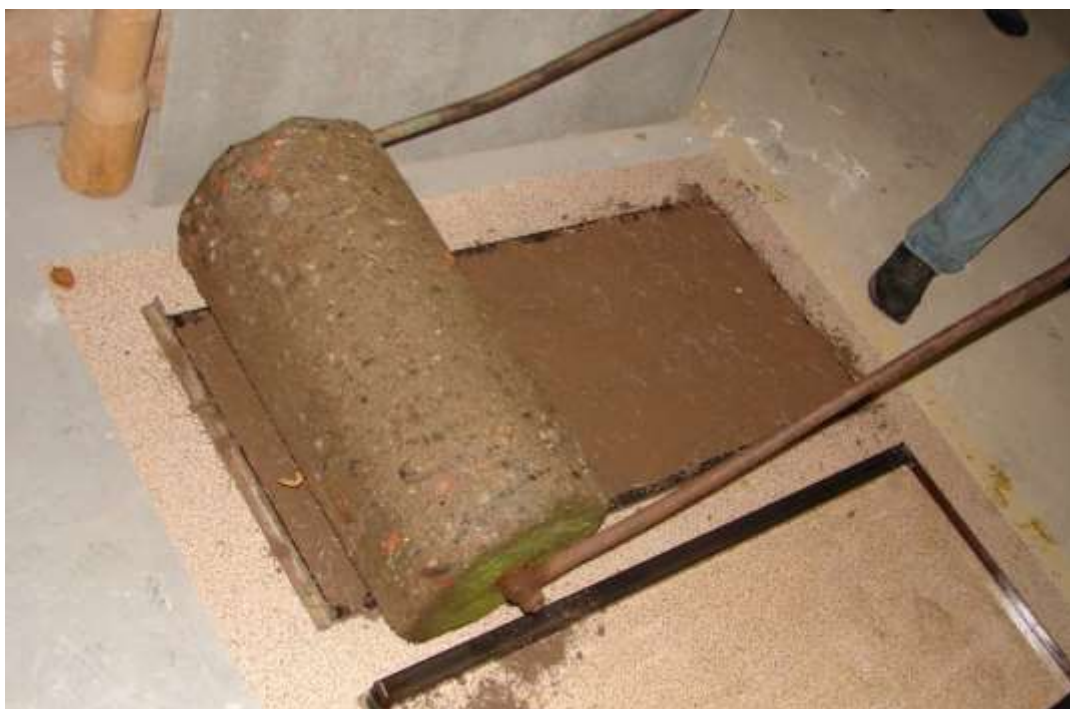
Obrázek 4-2 Válcování mezerovitěho vláknobetonu s recyklovaným kamenivem při výrobě laboratorního vzorku
