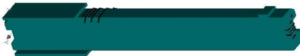
Obrázek 2-73 Trhliny při mezním zatížení spočítané v numerickém modelu předpjatého prvku
