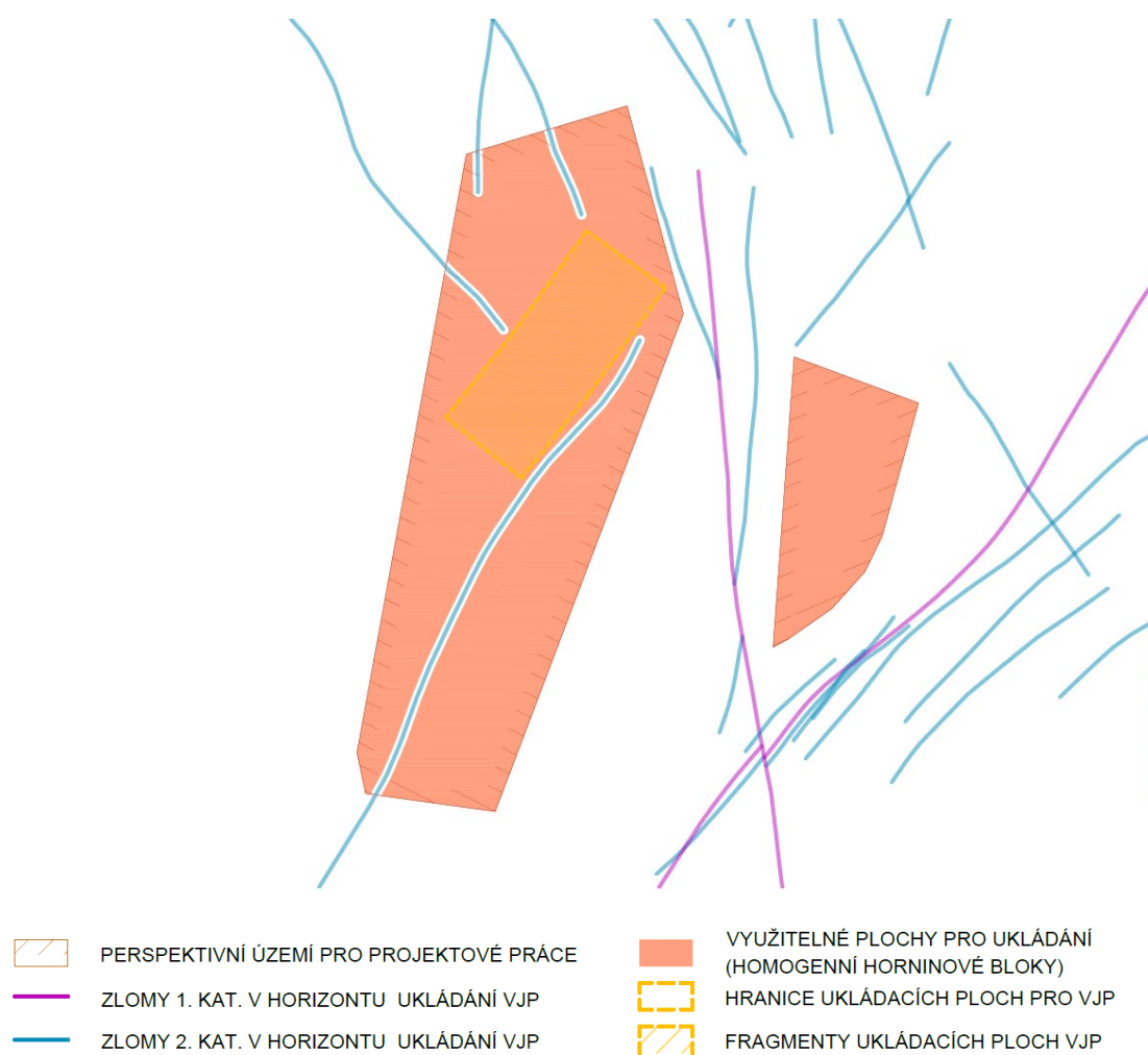
Obr. 3 – Využitelnost horninových bloků – lokalita Čihadlo
