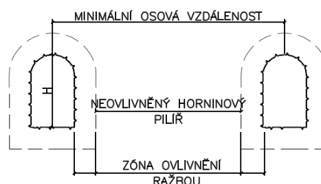
Obr. 9 – Princip stanovení minimální vzdálenosti mezi zav. chodbami / ukládacími vrtý
