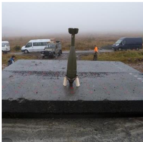
Obr. 142 Osazení minometného granátu na střechu segmentu.
