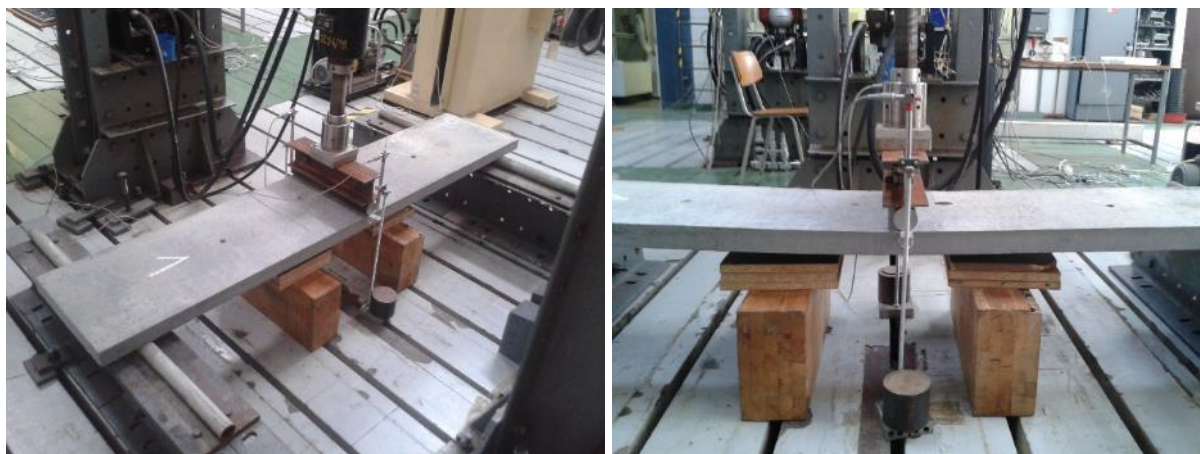
Obr. 104 Ukázka z prováděných zkoušek tříbodovým ohybem
