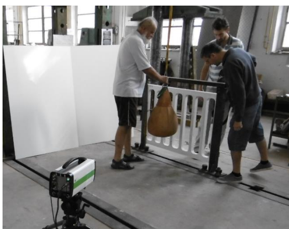
Obr. 90 Příprava dynamické zkoušky.
