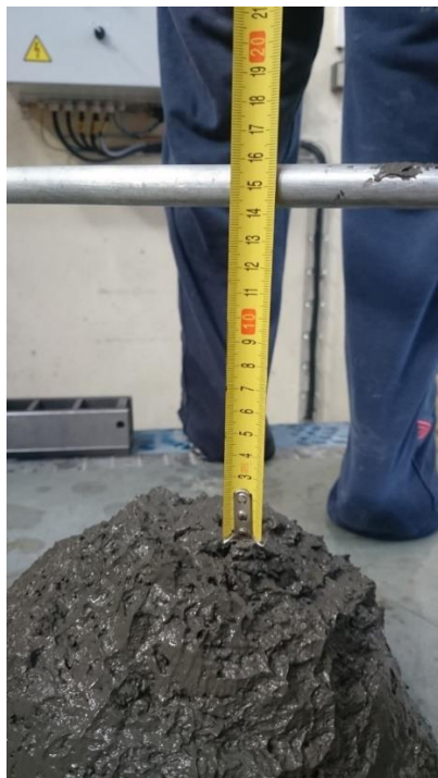
Obr. 64 Ukázka z měření konzistence metodou sednutí kužele u série A.
