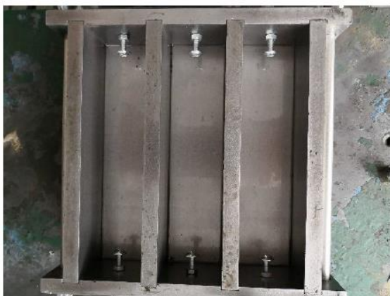
Obr. 43 Ukázka formy pro výrobu zkušebních těles se zabudovanými měřicími trny [67].
