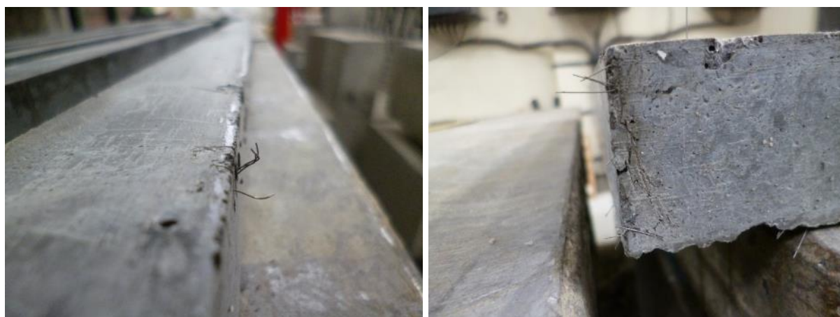
Obr. 75 Detaily hran s vystupujícími drátky.
