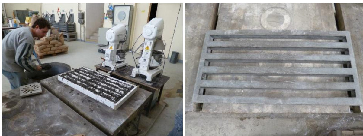
Obr. 74 Vlevo betonáž, vpravo hotový prvek.
