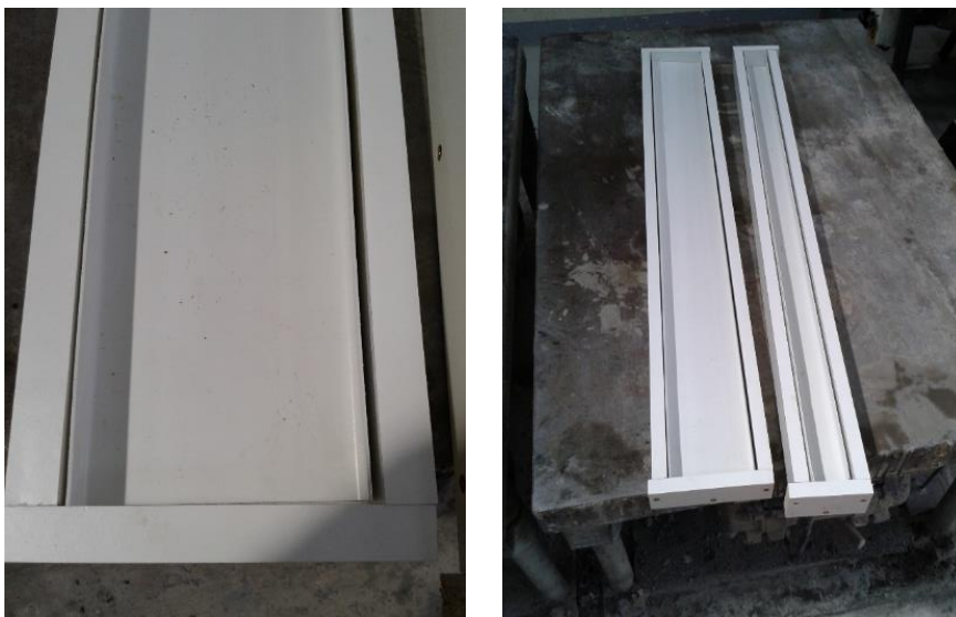
Obr. 76 Ukázka nového bednění.
