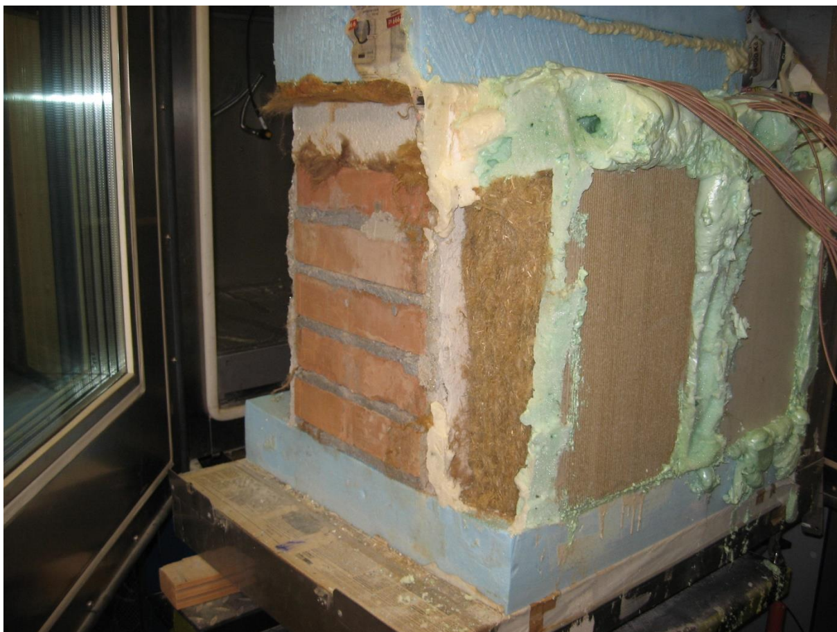
Obr. 49: Cihelné zidky opatrené tepelně izolačními systémy
