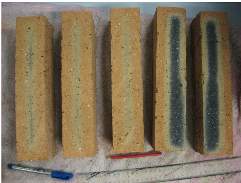
Obr. 54: Řez cihlou plnou pálenou
