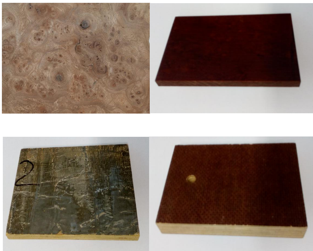
Obr. 8: a) Překližka s kořenovou dýhou b) zhuštěná překližka, c) překližka pojená cementem 2, d) stavební překližka
