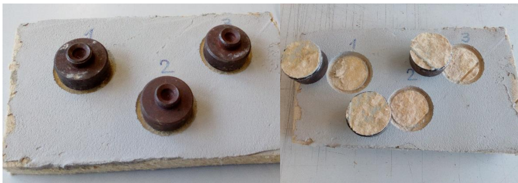
Obr. 42: Odtrhová zkouška u systému CIUR
