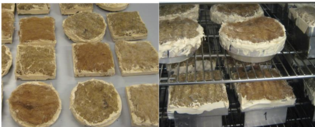
Obr. 31: Měření difúzních vlastností miskovou metodou
