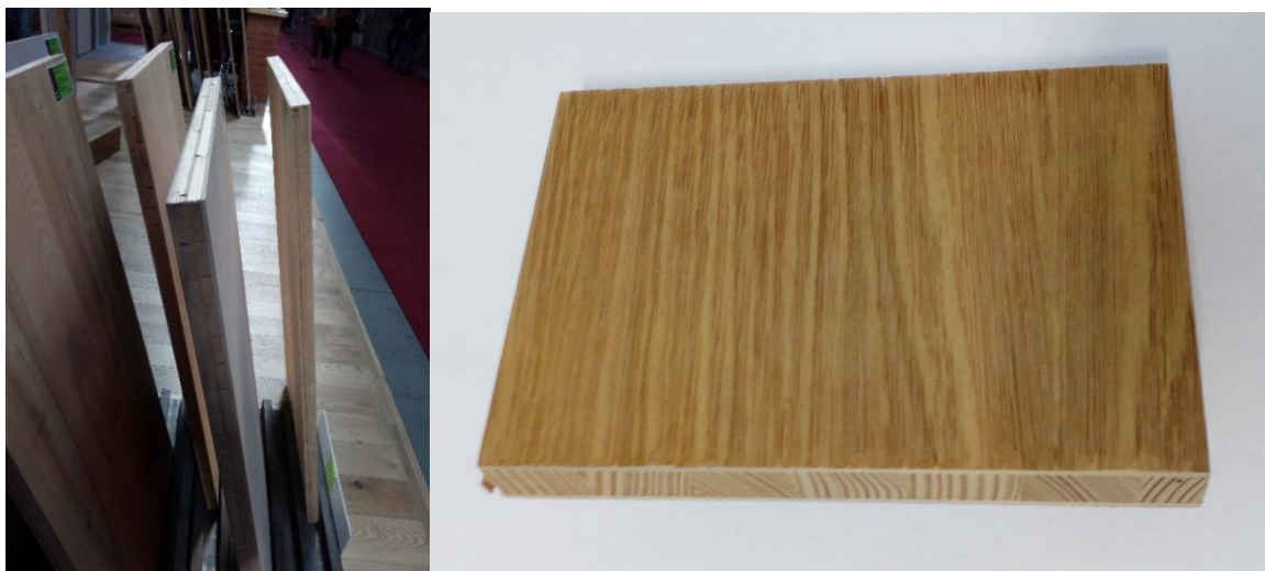
Obr. 9: A) Pětivrstvá zdvojená laťovka, b) pětivrstvá laťovka
