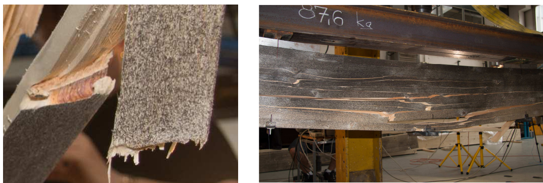
Obr. 3.5.1.3: Místo destrukce spodní lamely a dokumentace podélných trhlin nosníku.
