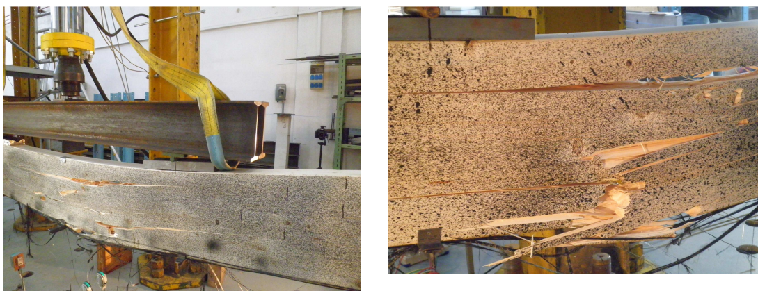
Obr. 3.5.2.1: Detaily poškození vyztuženého nosníku třetí série. Seskupené zubovité spoje jsou za oblastí největšího namáhání a rozlomení spodní lamely přes velký suk.
