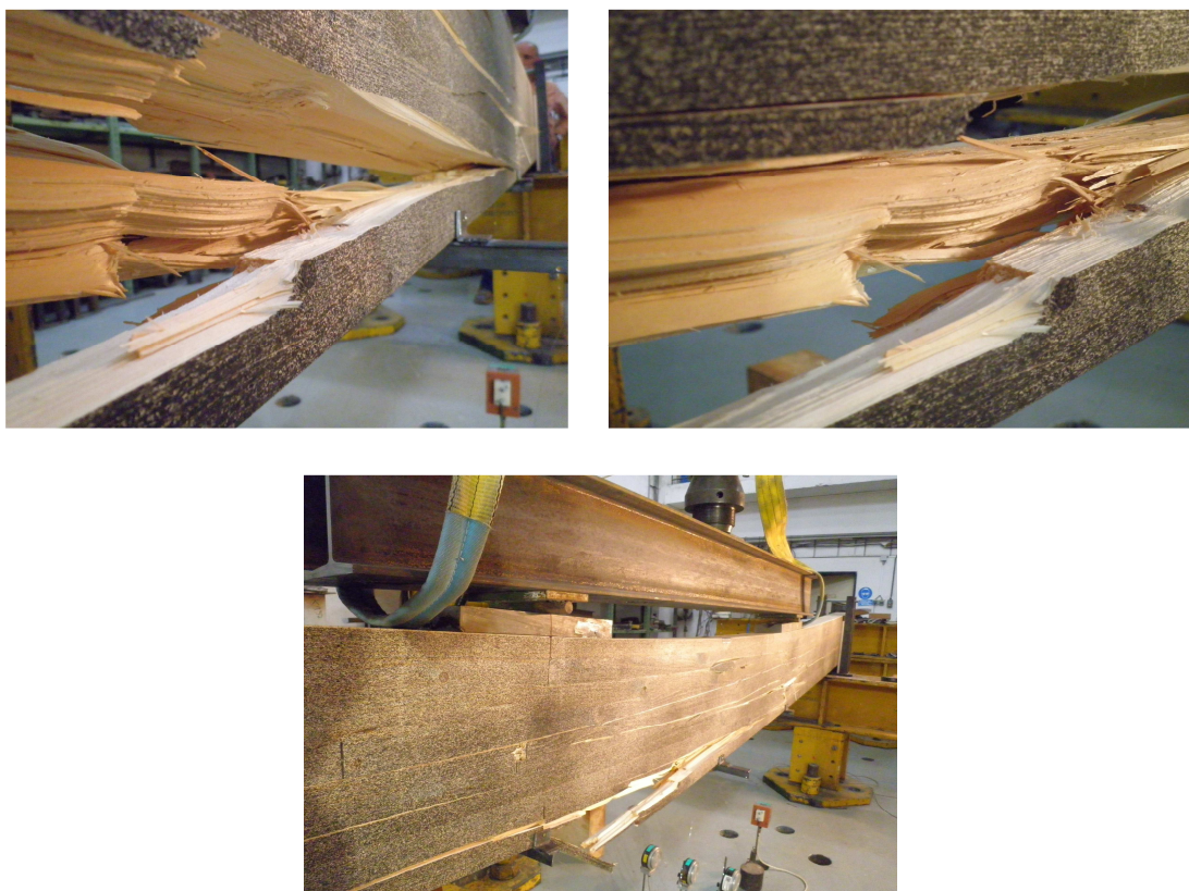
Obr. 3.5.1.1: Detaily místa vzniku první trhliny.
