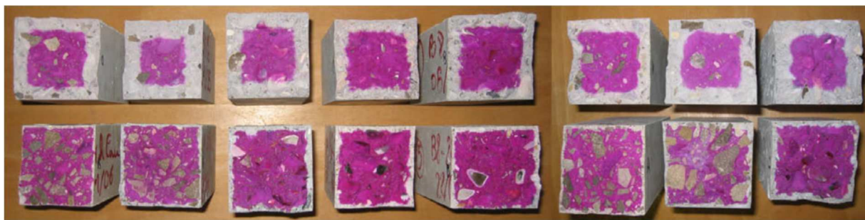
Obr. 3.3: Výsledky karbonatační zkoušky pro vzorky s popílkem pro různé režimy ošetřování (Roziere et al. , 2009).
