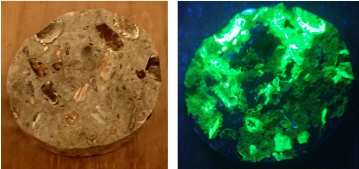
Obr. 3.2 Ukázka betonu postiženého ASR.
