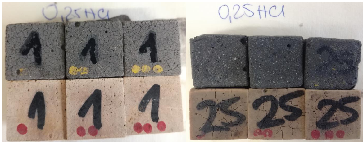
Obr. 51: Vzorky po 28 dnech (a) a 90 dnech (b) v 0,25 molárním roztoku kyseliny chlorovodíkové
