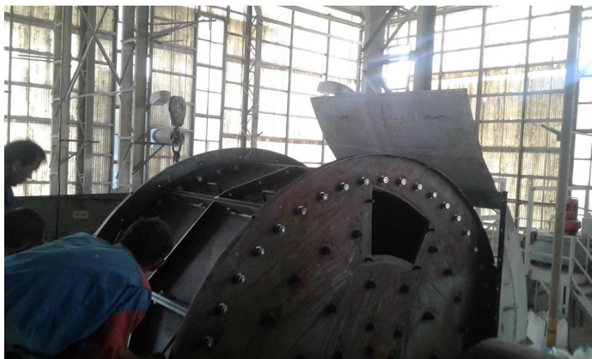
Obr. 81: Nový omílací buben poloprovozní výrobní linky pojiva SORFIX
