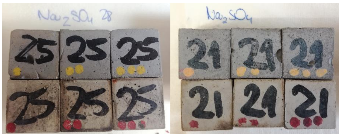
Obr. 43: Vzorky po 28 dnech (a) a 90 dnech (b) v roztoku síranu sodného
