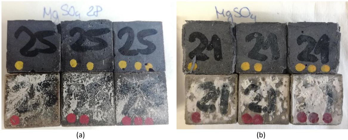
Obr. 45: Vzorky po 28 dnech (a) a 90 dnech (b) v roztoku síranu hořčnatého
