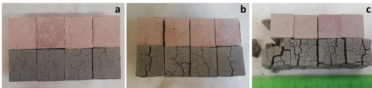
Obr. 67: Fotky těles S600 vystavených teplotě 600°C po dobu 14 dnů (a), 28 dnů (b) a 60 dnů (c), CEM – šedý vzorek, SFX – růžový vzorek, velikost vzorku cca 20 mm.
