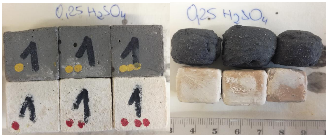
Obr. 53: Vzorky po 28 dnech (a) a 90 dnech (b) v 0,25 molárním roztoku kyseliny sírové
