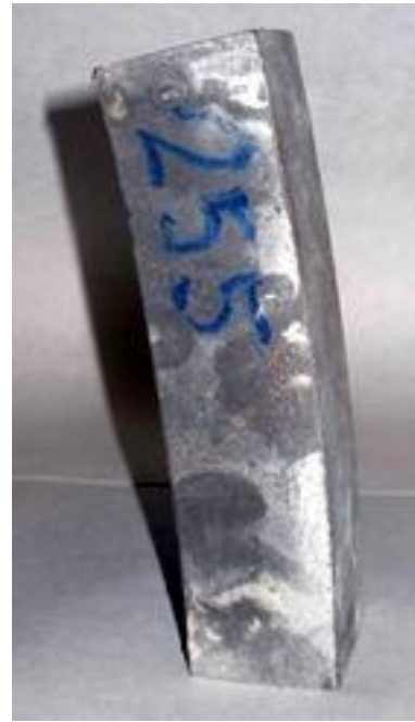
Obr. 6: Objemové změny těles 40x40x160 připravené ze sulfátovápennatého popílku s obsahem 8,8 hm.% volného vápna
