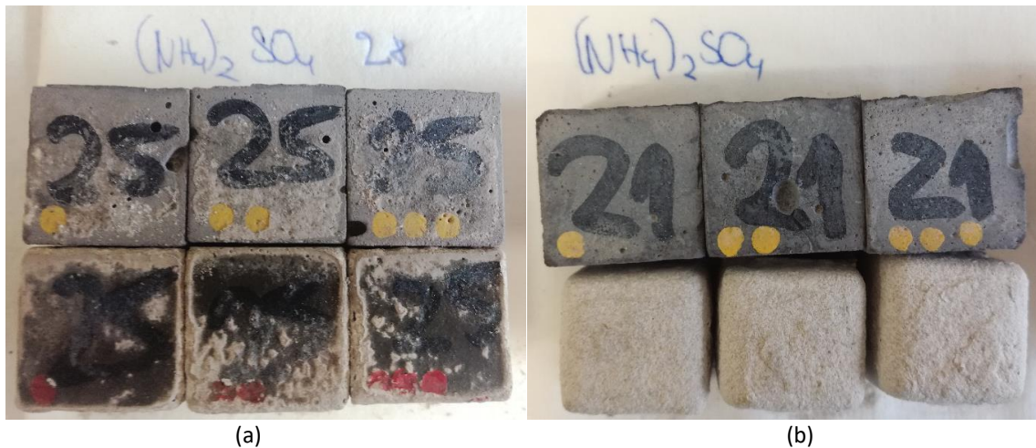
Obr. 47: Vzorky po 28 dnech (a) a 90 dnech (b) v roztoku síranu amonného
