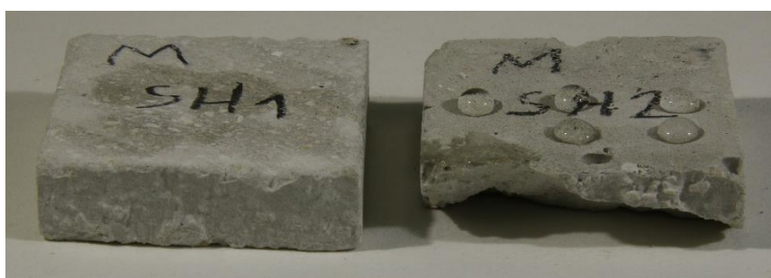
Obr. 51: Příklad povrchové hydrofobizace: vzorek referenční (vlevo) a ošetřený vzorek (vpravo).
