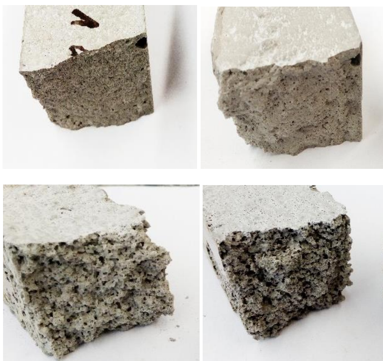
Obr. 35: Snímky lomových ploch testovaných vzorků, horní řada: C100/PH_a (vlevo) a C100/PM_a (vpravo), dolní řada: C100/PH_b (vlevo) a C100/PM_b (vpravo).
