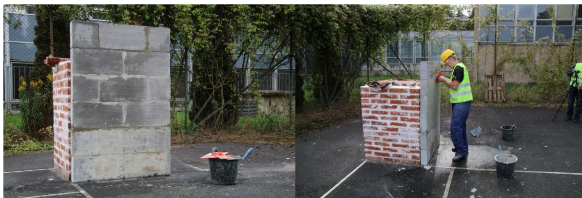
Obr. 58: Pohled na testovací stěnu z šedého pórobetonu s využitím navrženého lepidla (vlevo). Natahování vrstvy malty na testovací stěnu (vpravo) (stav stěny v květnu 2016).
