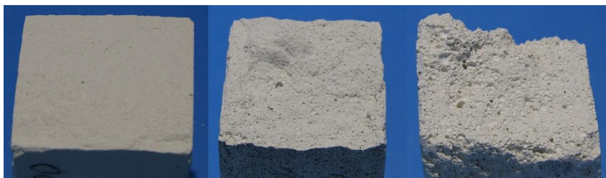
Obr. 55: Příklady vylehčení stejného základního materiálu pomocí pěny, plný referenční vzorek (vlevo), vylehčený vzorek s malým množstvím použité pěny (uprostřed) a vylehčený vzorek s vysokým stupněm vylehčení (vpravo).
