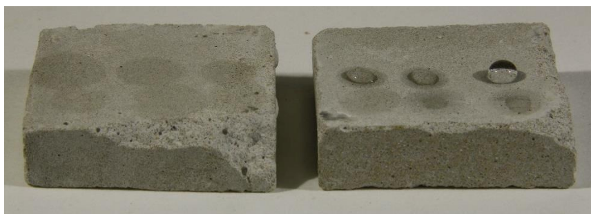
Obr. 52: Příklad objemové hydrofobizace: vzorek referenční (vlevo) a ošetřený vzorek (vpravo).
