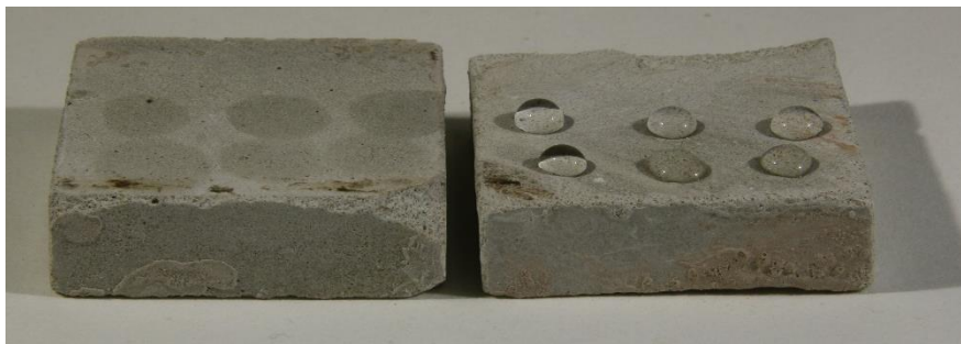
Obr. 50: Příklad povrchové hydrofobizace: vzorek referenční (vlevo) a ošetřený vzorek (vpravo).
