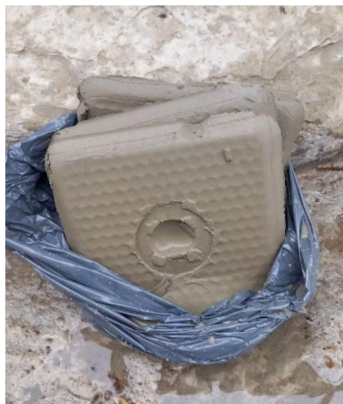
Obr. 10: Zařízení filter-press a vzniklý koláč CSW
