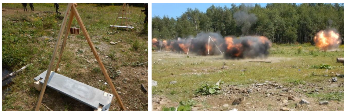
Obrázek 5.1: Umístění nálože a její pozice nad zkoušenou deskou na dřevěné trojnožce a provedení výbuchového experimentu na více deskách současně.
