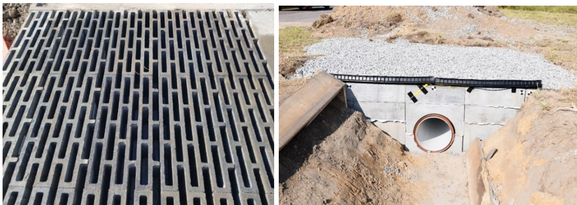
Obrázek 3.6: Jednotlivé deformační bloky usazené vedle sebe a samostatný sjezd v modelové situaci pro crash test.
