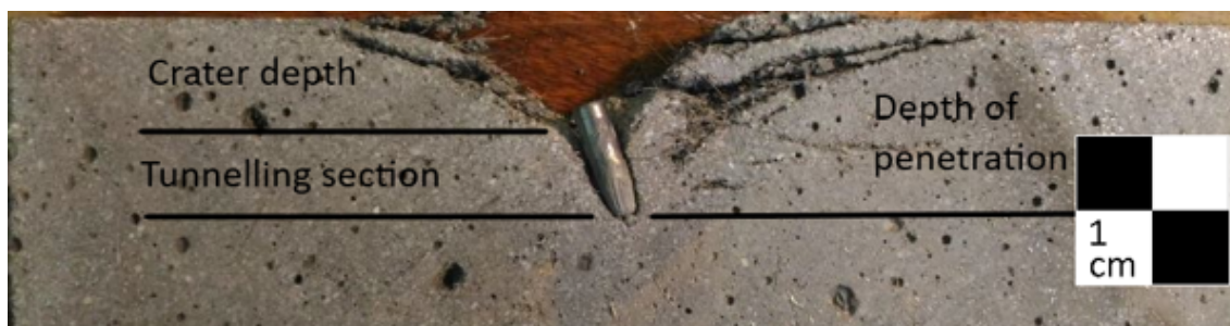
Obrázek 4.3: Řez polonekonečným cílem po zásahu střely s ocelovým jádrem a tvorbou čelního kráteru s tunelovacím kanálkem.
