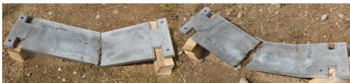
Obrázek 5.3: Globální porušení (GF) desky UHPC v důsledku výbuchu 1,2 kg TNT ze vzdálenosti 1 m (vlevo) a globální porušení (GF) desky UHPC v důsledku experimentu s výbuchem 2 kg TNT ze vzdálenosti 1 m (vpravo).
