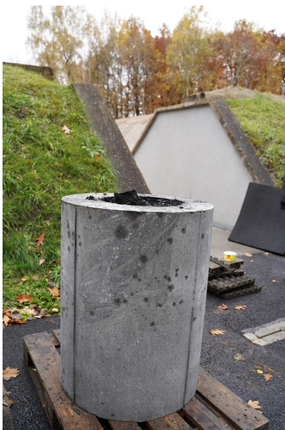
Obrázek 5.5: Stav koše po zkoušce: 500 g TNT na střed koše na přílož ke stěně – bez poškození a 1500 g TNT na střed koše na přílož ke stěně – výtrž u nálože.
