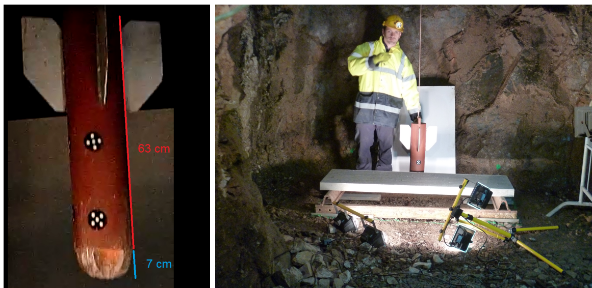
Obrázek 2.3: Detail ocelového projektilu s křídly, celkovou hmotností 95,4 kg, délkou 70 cm, hemisférickým nosem o poloměru 7 cm a jeho usazení nad středem zkušebního betonového vzorku ve tvaru desky s čistým rozpětím 1500 mm.
