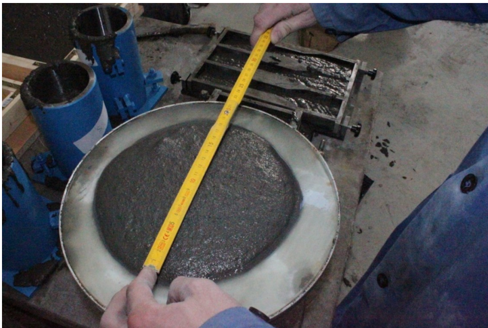
Obrázek 1.3: Rozlitá čerstvá směs UHPC měřená na setřásacím stolku.
