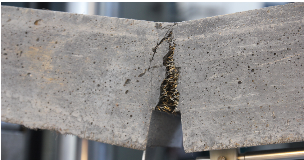
Obrázek 1.4: Zkoušení lomové energie UHPC a vytahování drátů z matrice.
