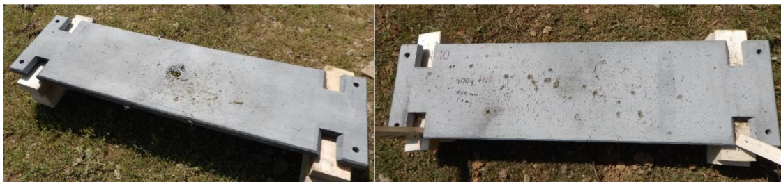
Obrázek 5.2: Lokální poškození (LD) desky UHPC v důsledku kontaktního výbuchu 75 g TNT (vlevo) a čelní eroze (FE) desky UHPC v důsledku výbuchového experimentu 400 g TNT z 1 m (vpravo).
