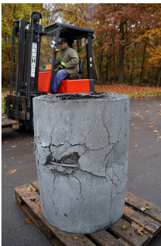
Obrázek 5.5: Stav koše po zkoušce: 500 g TNT na střed koše na přílož ke stěně – bez poškození a 1500 g TNT na střed koše na přílož ke stěně – výtrž u nálože.
