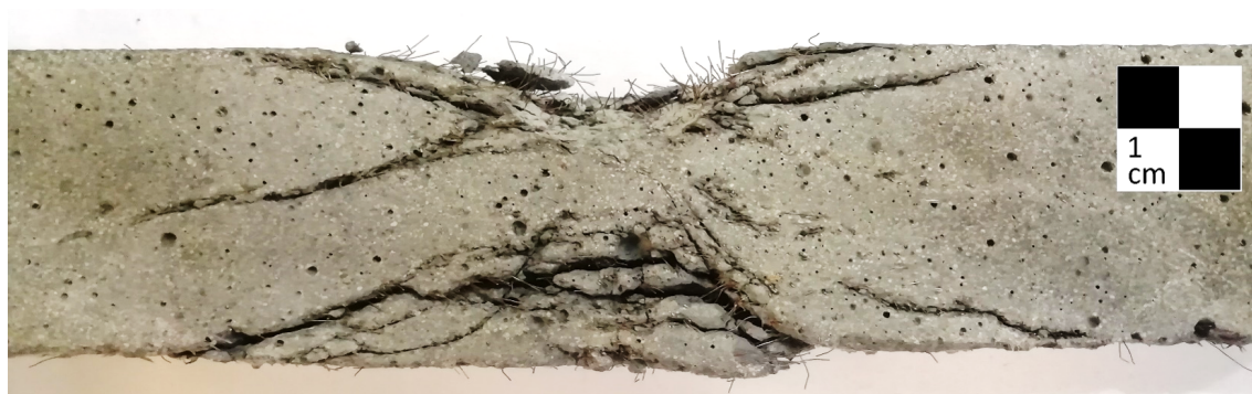
Obrázek 4.5: Řez tenkou deskou po nárazu projektilu s olověným jádrem a vnikem předního kráteru. Materiál na zadní straně vzorku je porušen, ale nedošlo k jeho uvolnění díky využití vláknité výztuže.
