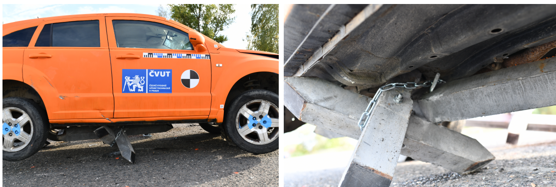
Obrázek 3.2: Mobilní zábrana po kontaktu s vozidlem a po jeho zastavení.
