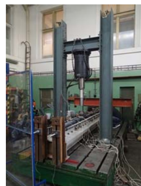
Interakce mostu a kontinuálně podepřené kolejnice při laboratorní zkoušce
