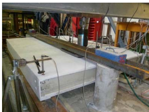
Mostovkový panel z materiálu GFRP pro provizorní most TMS při zatěžovací zkoušce
