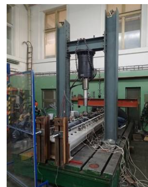
Interakce mostu a kontinuálně podepřené kolejnice při laboratorní zkoušce
