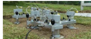
Automatický podtlakový infiltrometr MultiDisk při měření v terénu
