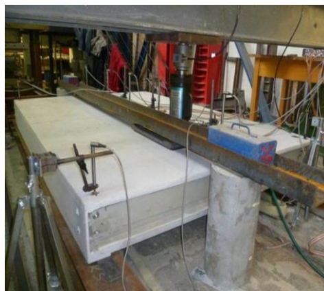
Mostovkový panel z materiálu GFRP pro provizorní most TMS při zatěžovací zkoušce
