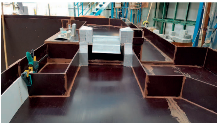
Hydraulický výzkum bezpečnostního přelivu poldru Kutřín na fyzikálním modelu.
