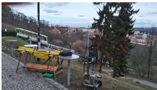
Sledování 3D svahových deformací lokal Nebozízek
