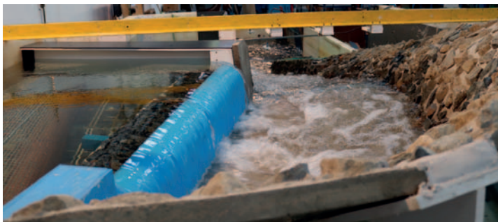
Hydraulický výzkum bezpečnostního přelivu poldru Kutřín na fyzikálním modelu.
