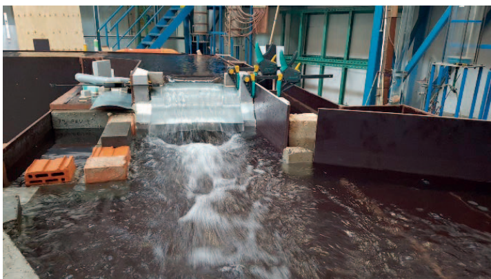
Na obrázcích: Pohled na suchý fyzikální model „dvoupatrové řešení“ průtoku vody do vodopádu h = 2\text{ m} ; Vodopád s modelovým průtokem vody v horním (skutečnost 2,5\text{ m}^3/\text{s} ) i dolním patru (skutečnost 6\text{ m}^3/\text{s} ).
